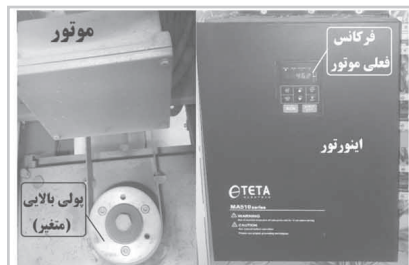
شکل ۱: اینورتور و موتور دستگاه دولاتی و پولی متغیر آن
