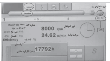
شکل ۱۰: نمای کلی از صفحه اول مانیتور (نمایش تنظیمات اصلی ماشین)
