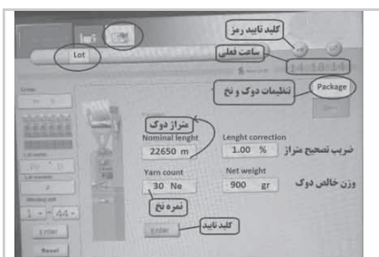
شکل ۴: تنظیمات دوک و نخ (متر از دوک، نمره نخ و ...)
